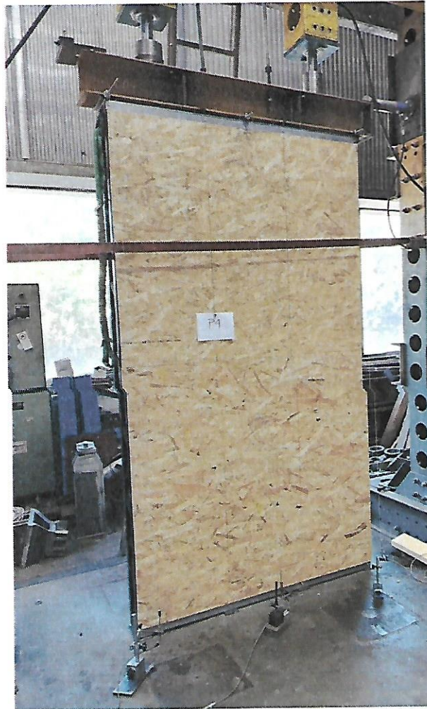
10. ábra: Függőleges terhelésre előkészített próbatest
