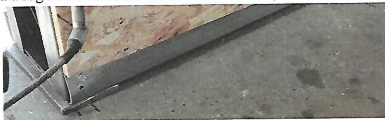
11. ábra: Terhelés hatására deformálódott alsó U profil
