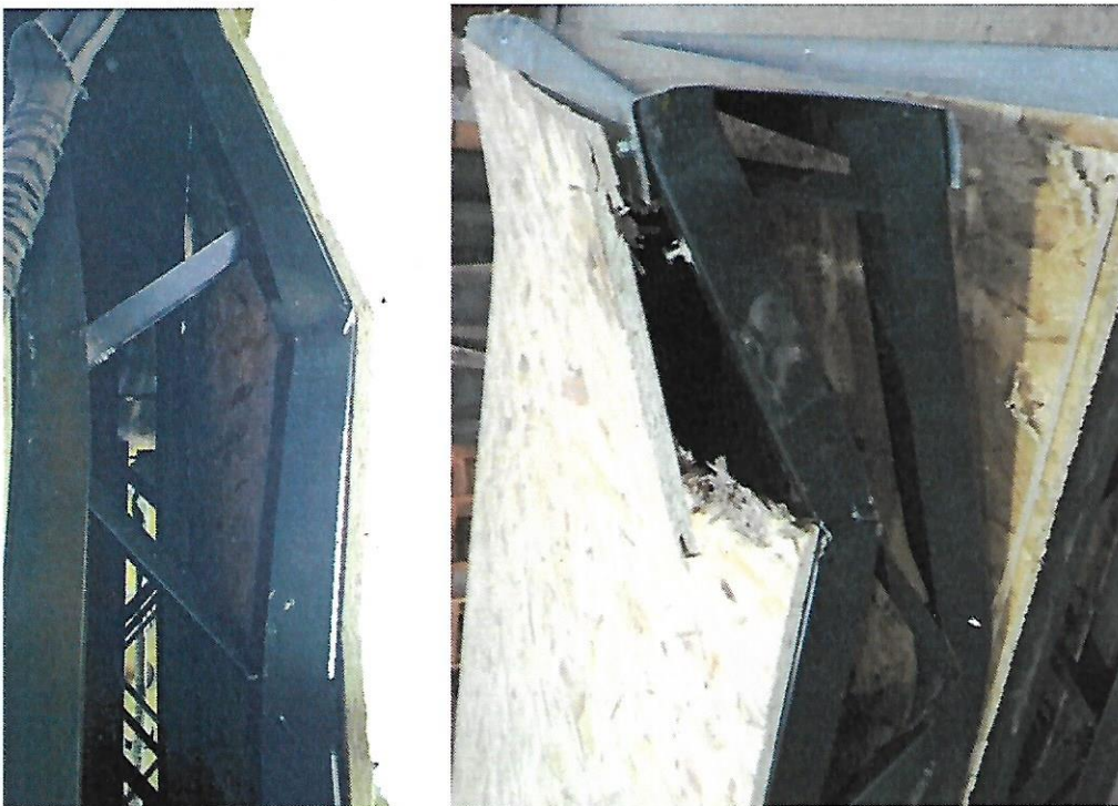
12. ábra: Rúdszerű tönkremenetel két próbatesten
