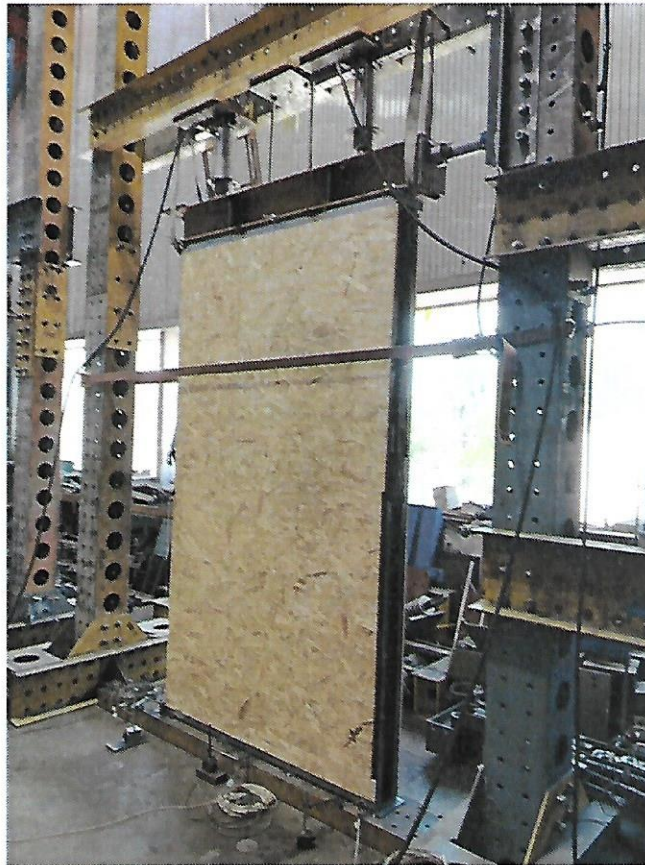
4. ábra: Panel előkészítve a vízszintes terhelésre
