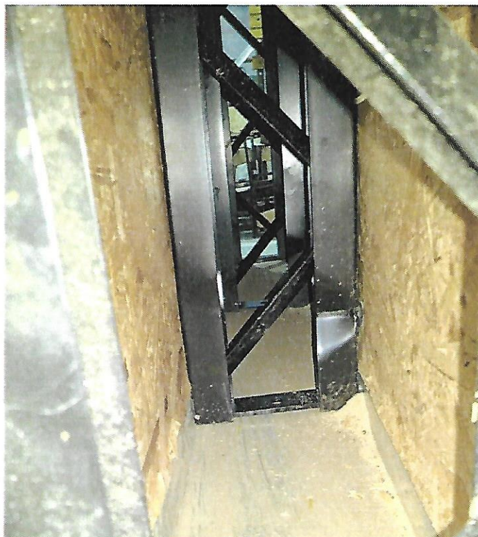
15. ábra: Lokális horpadás a teherbírás kimerülése nélkül
